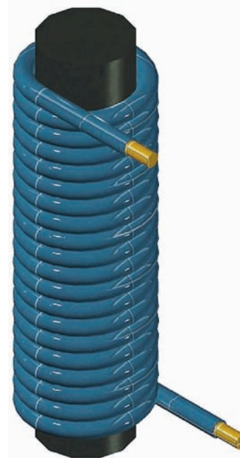
Простейший электромагнит: на ферромагнитный сердечник намотан электропровод в изоляции
